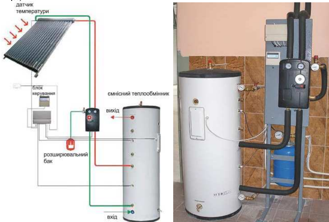
Рис. 1. Схема сонячного водонагрівача
