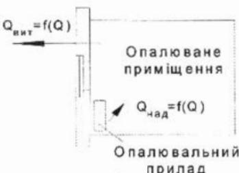
*Рис. 2 Схема процесу самовирівнювання температурного режиму приміщення на сторонах витрати та надходження теплової енергії*
