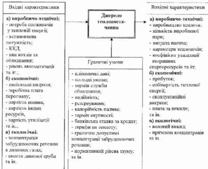
Рис. 3. Схема показників ефективності джерела теплопостачання
