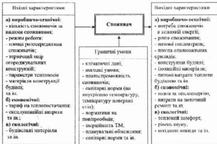
Рис. 5. Схема показників ефективності теплоспоживання споживачів теплоенергії
