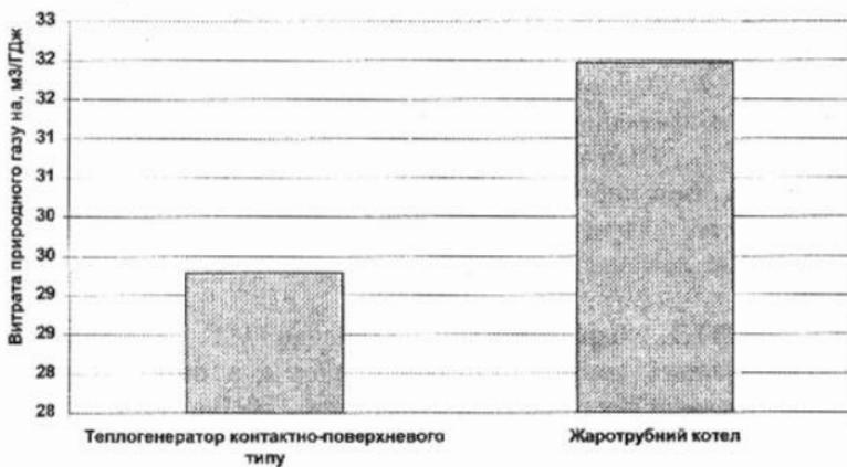
*Рис.6 Витрата природного газу на 1 ГДж виробленого тепла теплогенератором контактно – поверхневого типу ТГа-2,0 в промислових умовах та жаротрубним котлом (розрахункова при ККД=92 %) протягом лютого 2012 р.*
