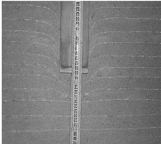
Рис. 2. Зони переміщення ґрунту навколо: а) таврової палі (вид Б, переріз 4-4); б) квадратної палі (переріз 2-2).
