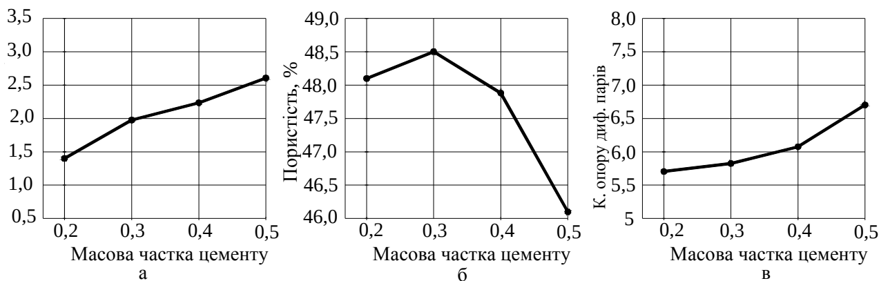
Рис. 1. Графіки зміни основних показників цем'янового розчину при збільшенні цементу в його складі: а – міцність, б – пористість, в – коефіцієнт опору дифузії водяної пари.
