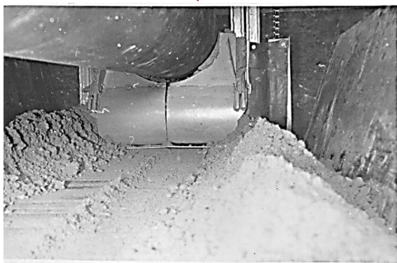
Рис. 2. Модель підкопувальної машини: а) – загальний вигляд; б) – вигляд під трубою після проходу обладнання.
