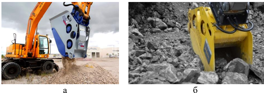
Рис. 2. Дробильні ківші з двома ексцентриковими валами: а – компанії Xcentric; б – компанії Epiroc Fig. 2. Crushing buckets with two eccentric shafts: а – Xcentric companies; б – Epiroc company
