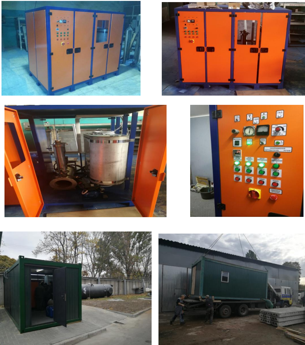
Рис. 4. Загальний вигляд установки «Плазмон-3» для плазмохімічного піролізу медичних відходів Fig. 4. General view of the "Plasmon-3" installation for plasma chemical pyrolysis of medical waste
