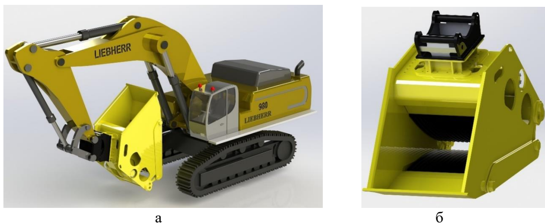
Рис. 14. 3D модель навісного дробильного ківша розробленого на кафедрі МОТП: а – дробильний ківш з базовим екскаватором; б – дробильний ківш Fig. 14. 3D model of the hinged crushing bucket developed at the Department of Mechanical Engineering and Technology: a – a crushing bucket with a basic excavator; b - crushing bucket
