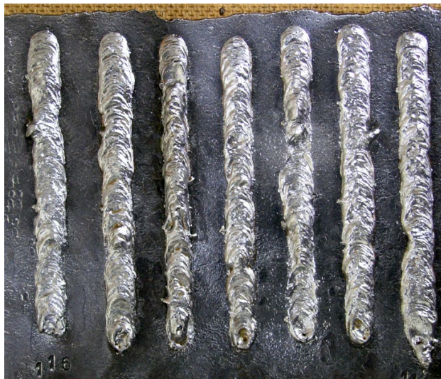
Рис.3. Валики, наплавленні в водній середі з використанням імпульсної подачі електродної з різними характеристиками – частота, амплітуда, скважність
