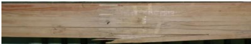
Рис.6. Характер руйнування дощатоклеєної балки БДК-1
