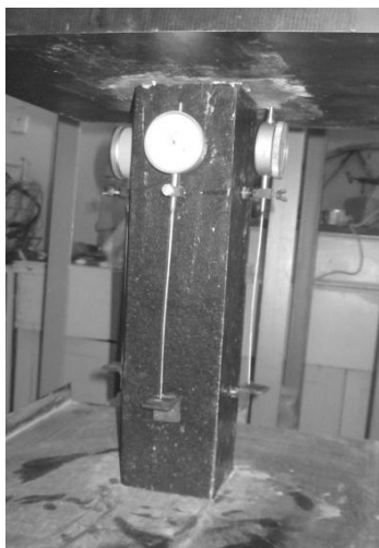
Рис. 2. Випробувані зразки призм та кубів виготовлені з суміші бетону і клею.
