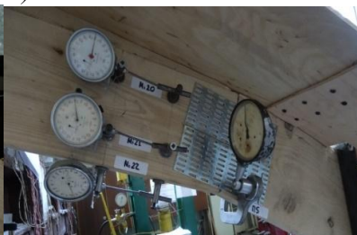
Рис. 4. Розташування вузлів кріплення мікроіндикаторів (а), вузол С арки АП-1(б) та АТ-1(в)
