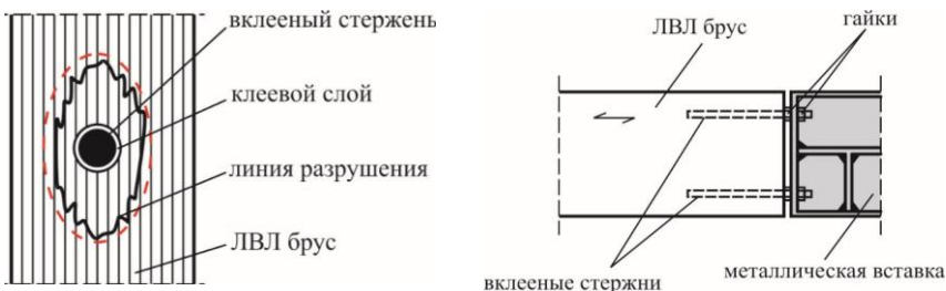
а) модель овализации области скалывания древесины
