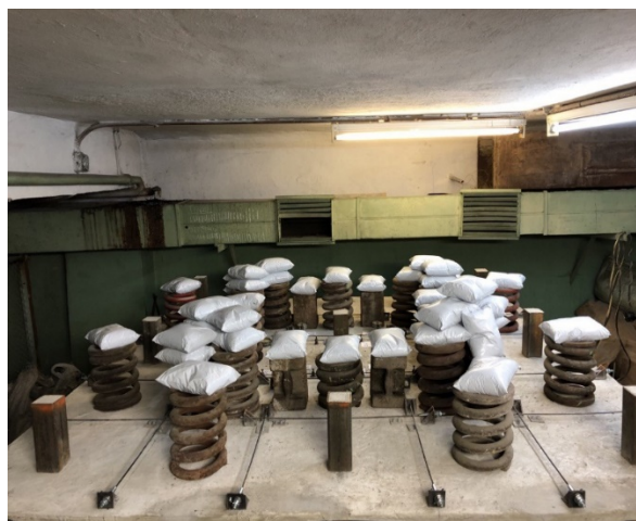
Рис.6. Завантаження експериментальної моделі. 2 етап – сумарне навантаження 581 кг.
