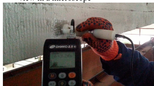
Рис.10. Визначення міцності бетону приладом «Онікс-2,5» в балці покриття.
