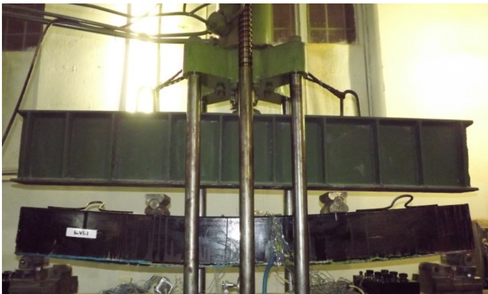
Рис.2. Типова картина прогину та розтріскування сталезалізобетонної балки, підсиленою сталевую пластинною
