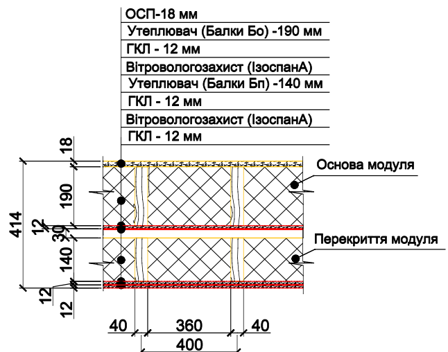
Рис.3. Поперечний переріз перекриття будинку
