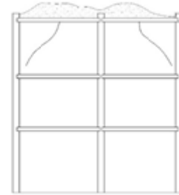
Рис. 11. Типовий характер тріщин на верхньому поверсі після пожежі на даху
