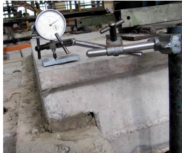
Рис.3. Загальний вигляд плити: а - вузол спирання; б - на стенді під час випробування Fig.3. Overall view: a - notch at the support of the slab; b -during the test
