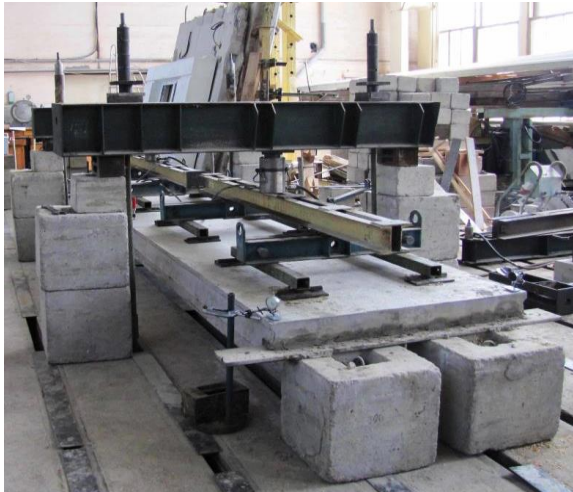
Рис.3. Загальний вигляд плити: а - вузол спирання; б - на стенді під час випробування Fig.3. Overall view: a - notch at the support of the slab; b -during the test
