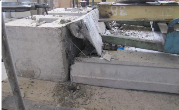
Рис. 4. Характер руйнування плити на опорах у місцях підрізок: а) ліва опора; б) права опора Fig.4. Failure type of the end-notched slab at the support: a) left support; b) right support
