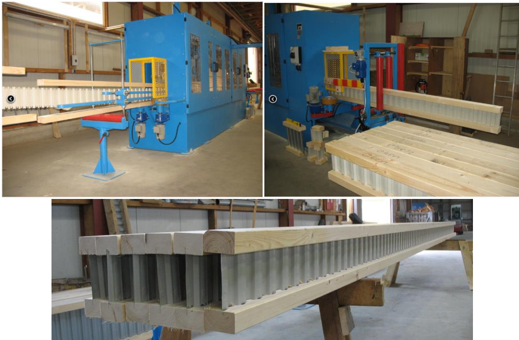
Рис.2. Технологічна лінія з'єднання сталевих стік з поясами з деревини Fig.2. The technological line for connecting steel joints with timber belts
