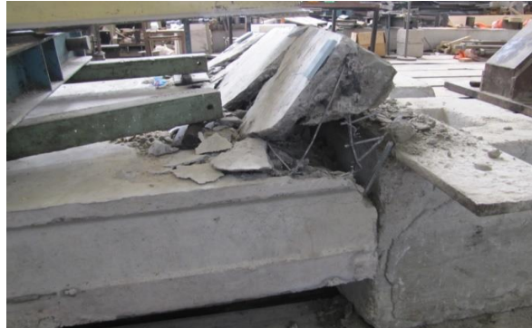
Рис. 4. Характер руйнування плити на опорах у місцях підрізок: а) ліва опора; б) права опора Fig.4. Failure type of the end-notched slab at the support: a) left support; b) right support
