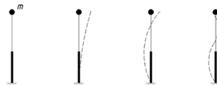
Рис.4 Розрахункова схема і три власних форми коливань
