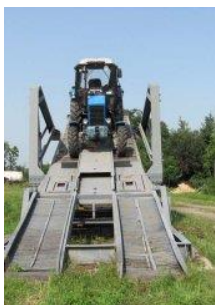
Рис.4. Випробувальний стенд на стійкість до перекидання
