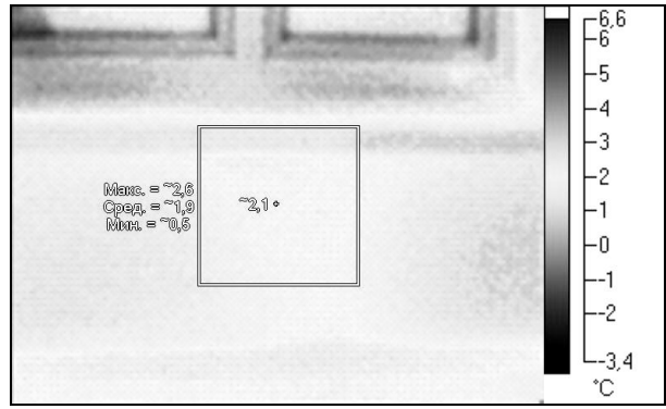
Рис.4 Тепловізійна візуалізація тепловтрат стіни
