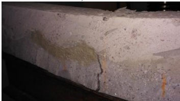
Рисунок 3. Характер руйнування відновленої балки після визначення міцність на згин
