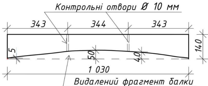
Рисунок 1. Схема балки підготовленої до відновлення
