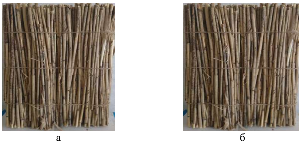
Рис. 1. Модельні зразки теплоізоляційних матів з очерету: а – необроблений; б – оброблений модифікованим покрівельним просочувальним розчином «Skela-i»
