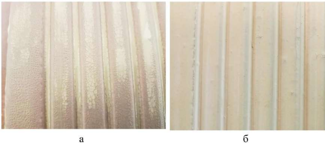
Рис. 1. Зовнішній вигляд керамічного виробу: а – ангоб з високим ТКЛР; б - гладкий ангоб на шорсткій поверхні
