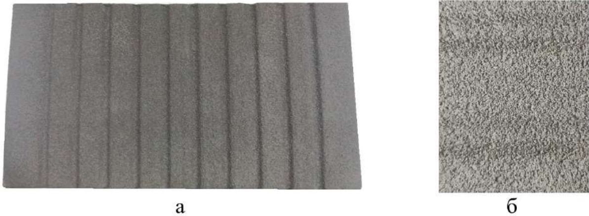
Рис. 2. Зовнішній вигляд виробу з фактурним ангобом №4cor: а – загальний вигляд, б – деталізація поверхні
