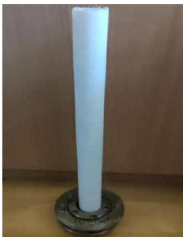
Рис. 2. Випробування тканини на водопроникнення
