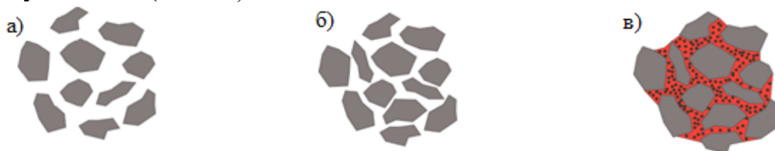
Рис. 2. Схематичне зображення структури звичайного бетону та НРС:
