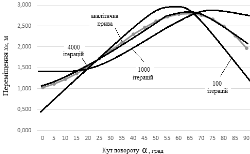
Рис. 6. Графік-порівняння теоретичних даних з результатами моделювання нейронної мережі для переміщення по координаті x_K при різних кількостях ітерацій
