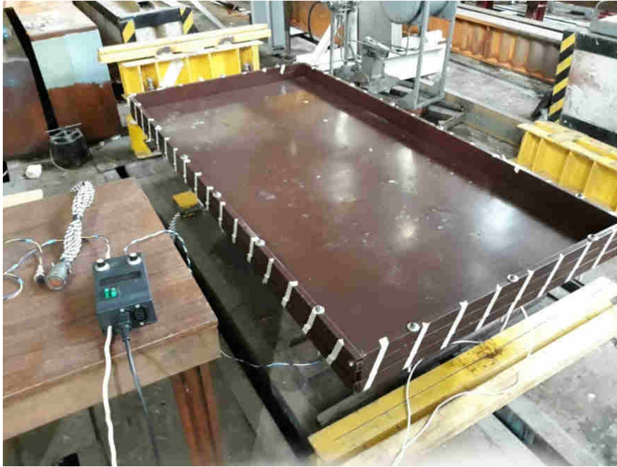
Рис.1. Експериментальна вібраційна установка
