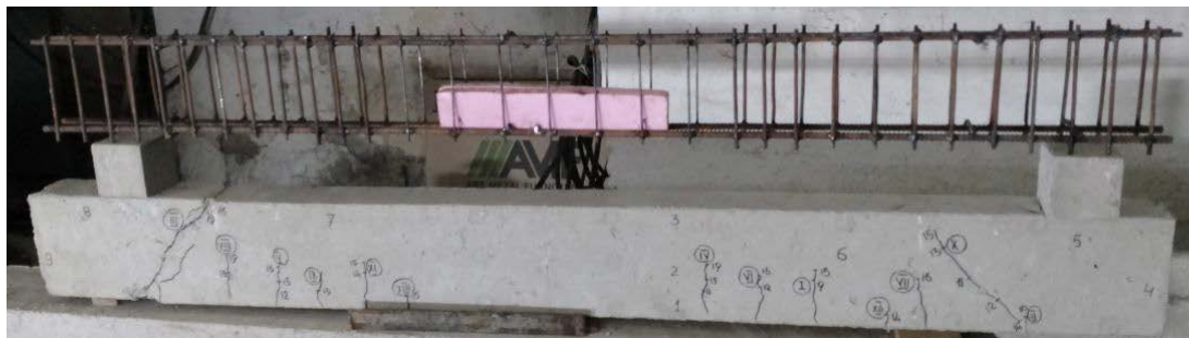
Рис. 3. Зразок балки, пошкодженої у розтягнутій зоні
