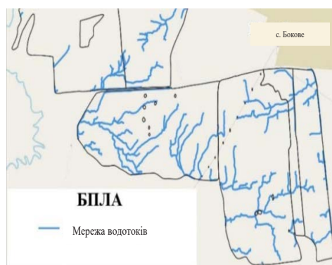
Рис. 7. Фрагменти тематичної геодезичної карти з розподілом шляхів потоків води: карта поверхневого стоку води (отримано авторами)
