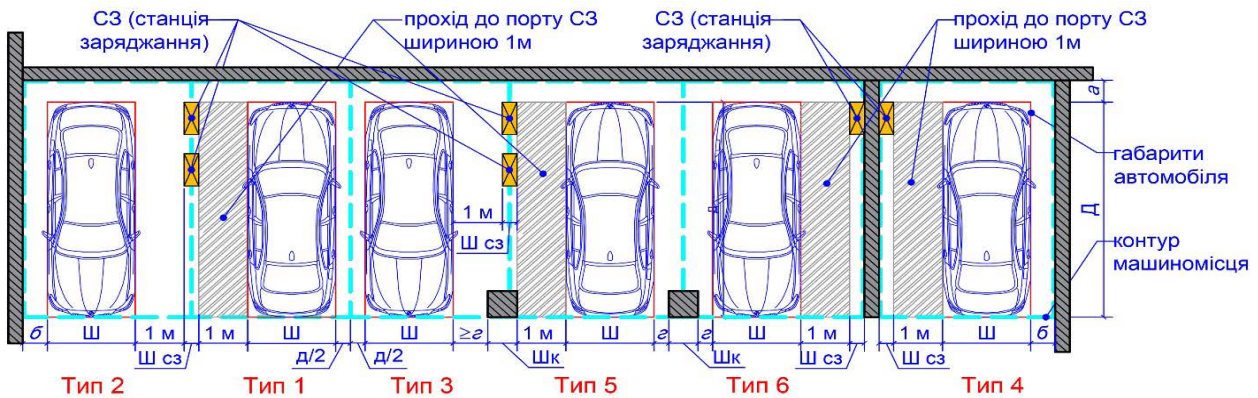
Рисунок 3. Типи машиномісць на зарядних пунктах в гаражах з розміщенням СЗ біля бокової сторони машиномісця
