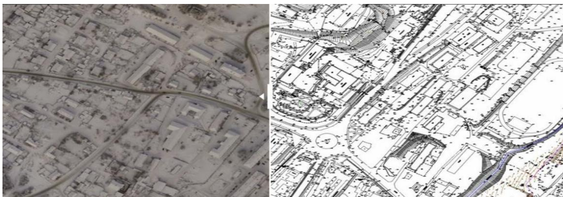
Рис. 3. Ортофотоплан та топоплан у масштабі 1:2000 [9]
