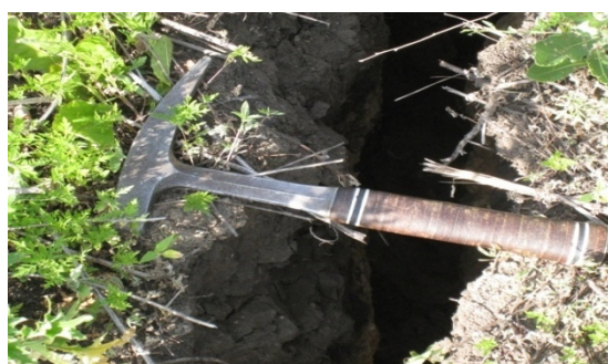
Рис. 2. Обвалення денної поверхні, що знаходилася в зоні гірничого відводу шахти ім. Орджонікідзе (13.06.2010 р.)
