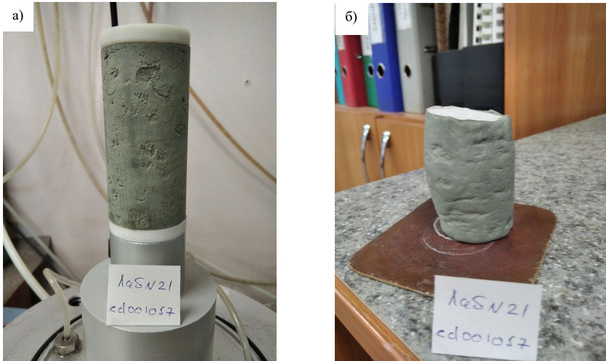
Рис. 5. Зразок ґрунту: а) до випробування; б) після випробування. Fig. 5. Soil sample: a) before triaxial test; b) after triaxial test.
