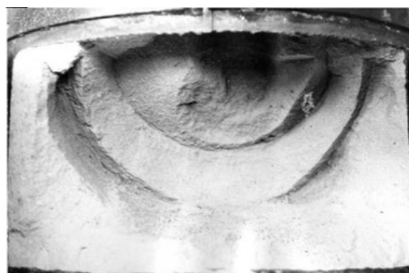
Рис.3. Загальний вигляд полос локалізації деформацій в піщаному ґрунті під подошвою сферичного штампa. Fig.3. General view of deformation localization bands in sandy soil under the sole of a spherical die.
