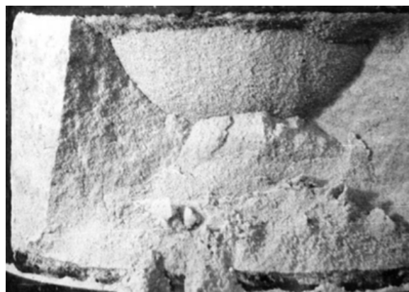
Рис.2. Напівсфера в піщаному ґрунті. Fig.2. Hemisphere in sandy soil.
