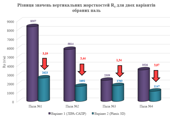
Рис.21. Діаграма порівняння вертикальних жорсткостей в обраних палях для двох варіантів розрахунку.
