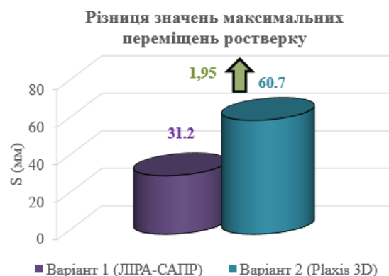
Рис.24. Діаграма порівняння значень максимальних переміщень ростверку для двох варіантів розрахунку.
