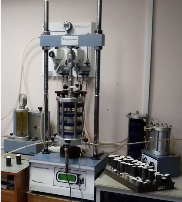
Рис. 4. Прилад тривісного стиску. Fig. 4. Standard Triaxial system.
