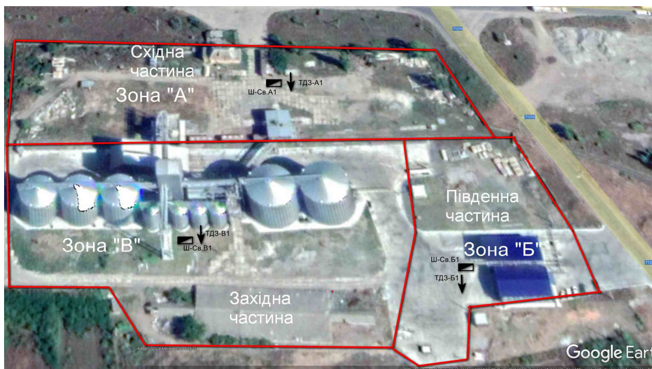
Рис.1. Поділ території виробничого комплексу на зони, залежно від ступеню ушкодження дорожнього покриття. Схема розташування точок "летючого" (первинного) контролю для отримання оперативної інформації про стан підготовки під покриття.
