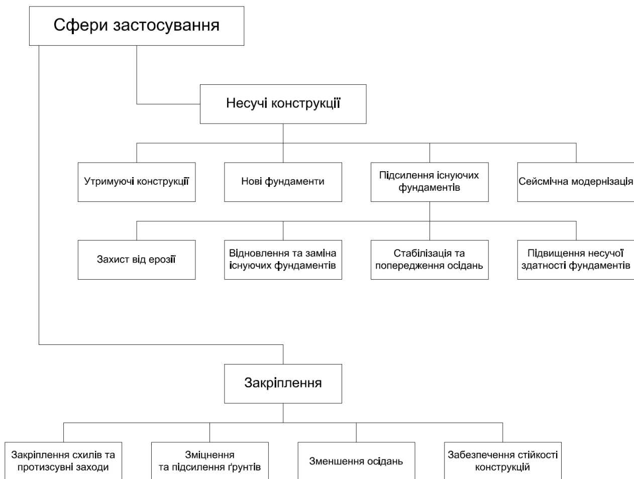
Рис.1. Сфери застосування бурових паль малого діаметру Fig.1. Small-diameter bored piles applications
