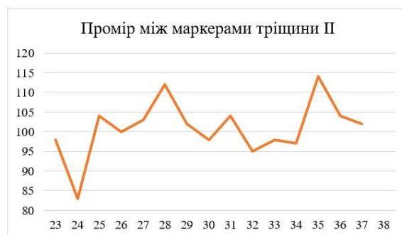
Рис.7. Приклад результатів проміру між маркерами тріщин.
