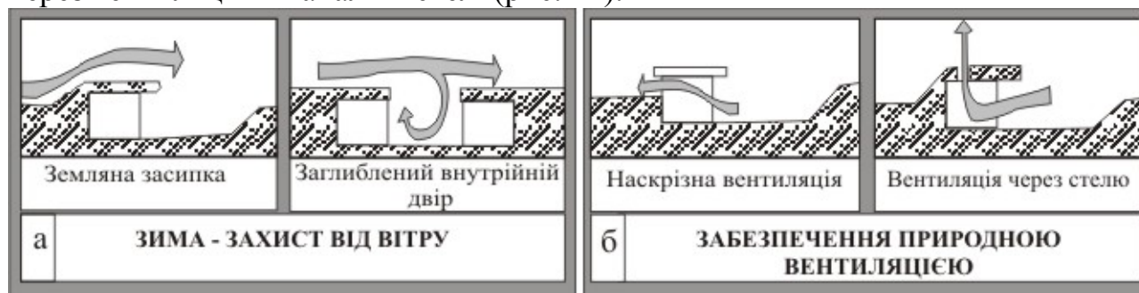
Рис. 12. Розташування внутрішніх дворів з урахуванням вітрового режиму місцевості (за матеріалами Г. Стерлінга [3])
