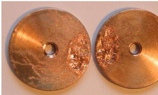
Рис. 3. Зовнішній вигляд контактів (першого типу) після зварювання в режимі короткого замикання 4,5кА (1000 В, 50 Гц, р 0,5)
