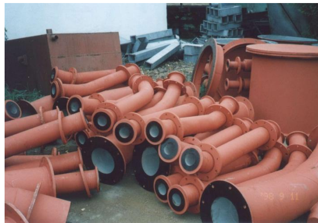
Рис. 1. Зовнішній вигляд труб і відводів, футерованих дрібнозернистим фібробетоном
